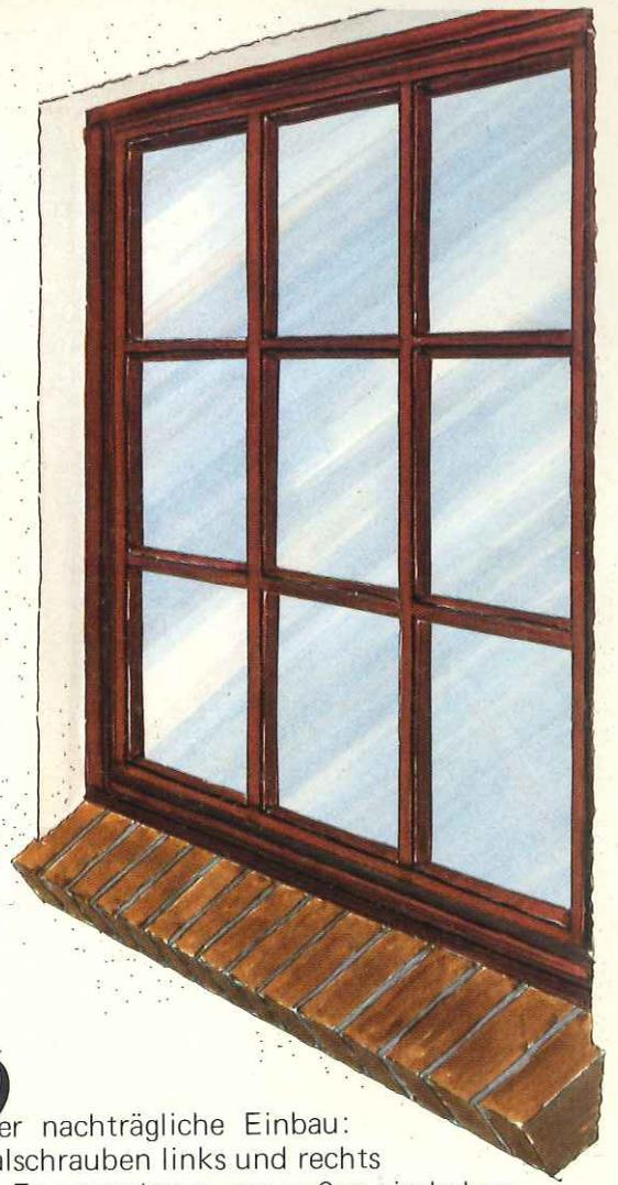
Der nachträgliche Einbau: Spezialschrauben links und rechts in den Fensterrahmen von außen eindrehen. Der rekord-Sprossenrahmen hat an jeder Seite Einreißer, einhängen - fertig!
